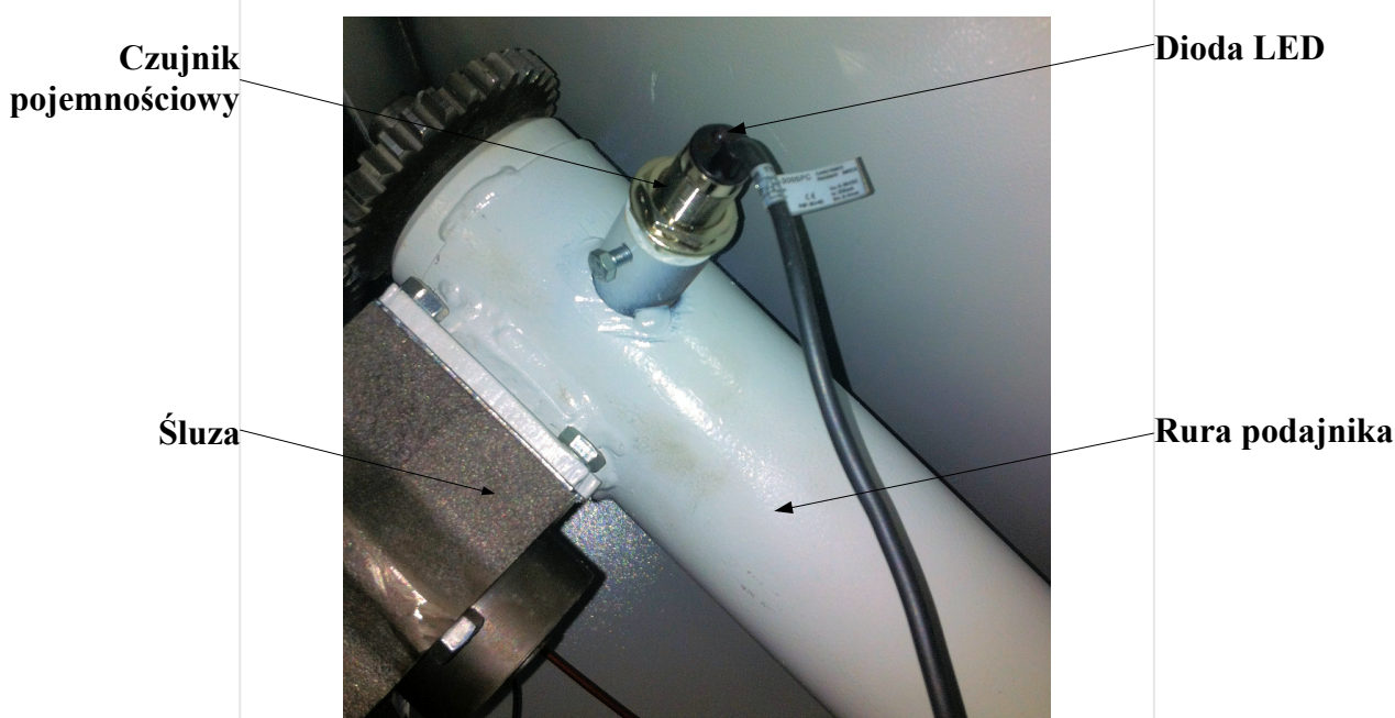
Rys nr 8. Umieszczenie pojemnościowego czujnika zbliżeniowego
