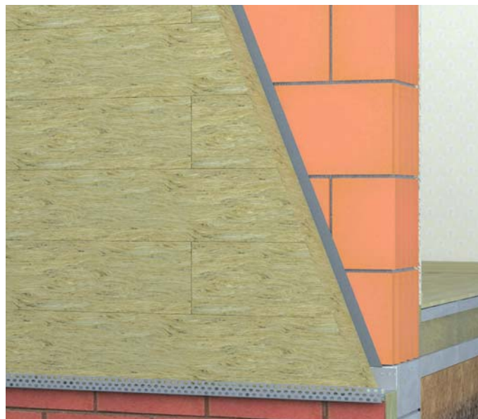
WIZ. 112.2. Klejenie lamelowych płyt fasadowych FASROCK-L zaprawą klejącą ZK-ECOROCK
