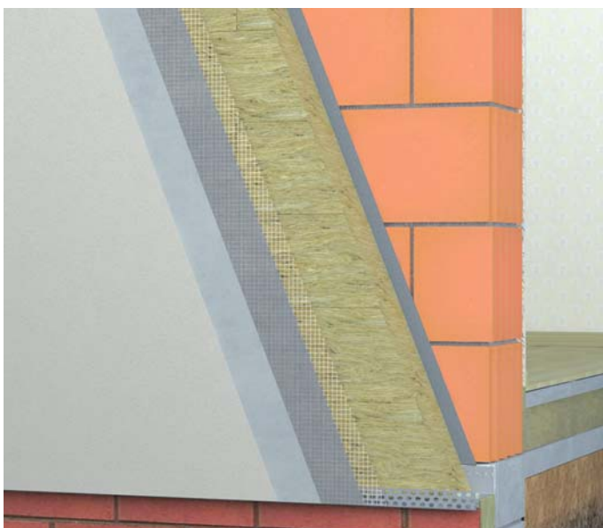
WIZ. 112.5. Nałożenie tynku mineralnego BR-ECOROCK
