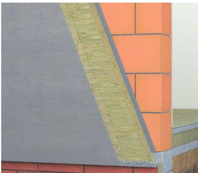
WIZ. 112.3. Nałożenie zaprawy zbrojącej ZZ-ECOROCK i wtopienie siatki zbrojącej SZ-ECOROCK
