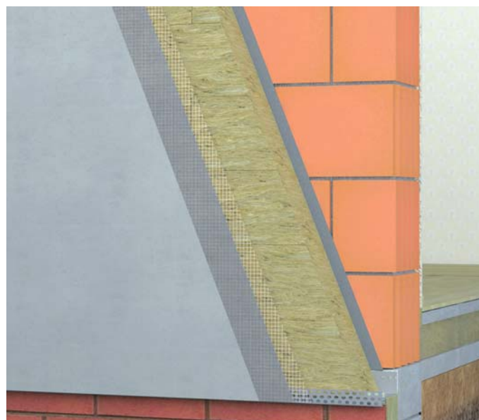
WIZ. 112.4. Malowanie podkładem tynkarskim PT-ECOROCK
